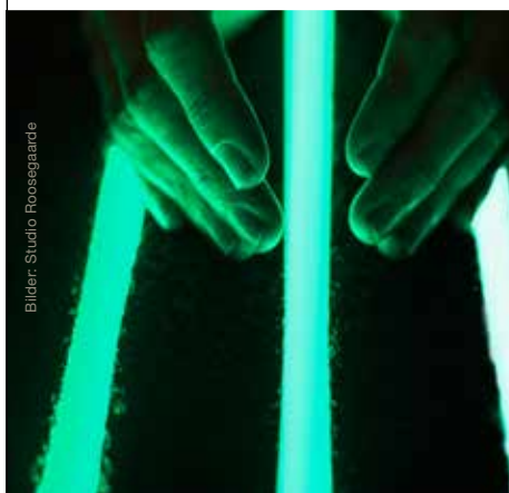
Die grünen Farbstreifen am Fahrbahnrand speichern tagsüber das Sonnenlicht, das sie nachts leuchten lässt.
